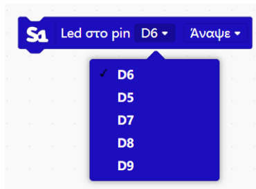
Εικόνα 5 - Πτυσσόμενες λίστες για ελαχιστοποίηση λαθών συδεσμολογίας
